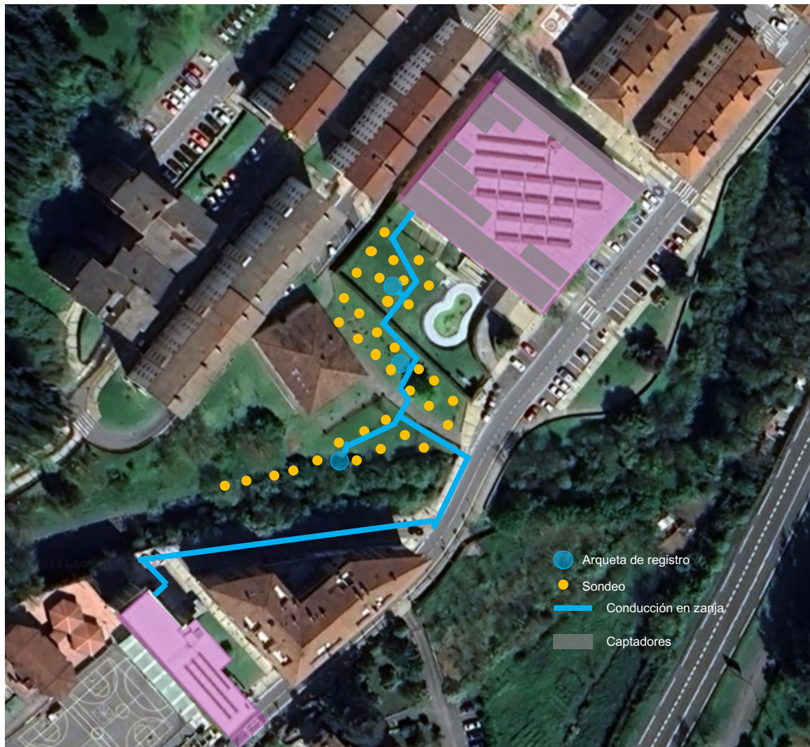
Figura 12. Distribución sondeos y conducciones
