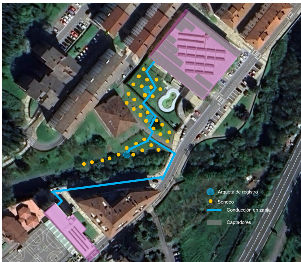
Figura 5. Plano del sistema urbano de climatización
