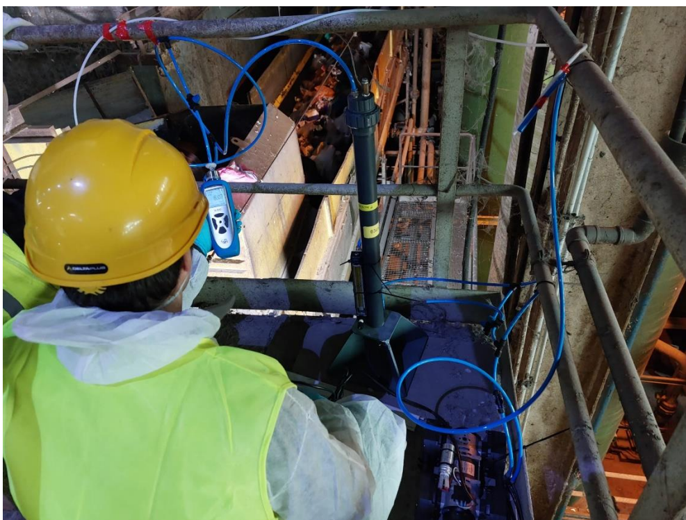
Figura 4. Medición de concentración total de COV mediante un sensor de fotoionización FID portátil circulando aire de Ecoparc 3 en una columna de zeolitas.. Fuente: Elaboración propia, LIFE ABATE.
