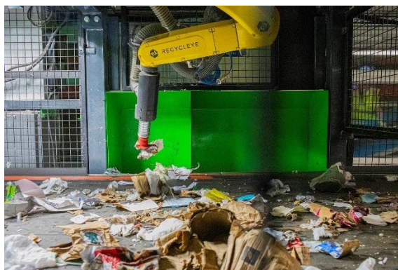
Figura 4. Robot de clasificación de residuos con Inteligencia Artificial. Fuente: Recycleye.
