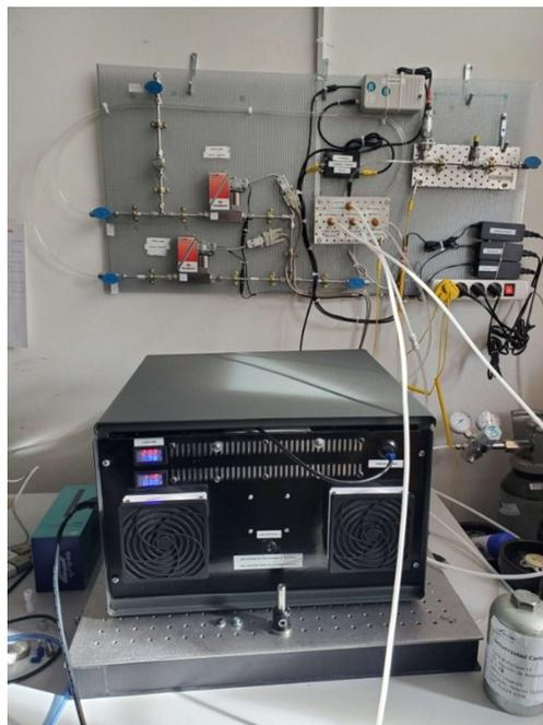
**Figura 6.4.** Aspecto exterior del instrumento completo junto con el sistema de mezcla de gases para realizar pruebas.
