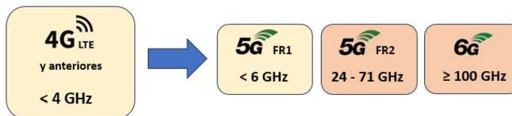
**Figura 9.1.** Bandas de frecuencia utilizadas en la red de acceso: evolución del 4G al 5G y 6G de ondas milimétricas.
