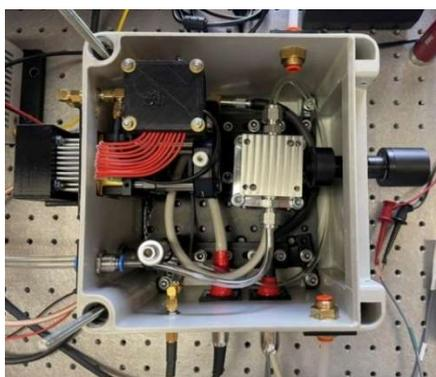
**Figura 6.2.** Disposición de los componentes del módulo de detección fotoacústica dentro del contenedor de polímero reforzado.
