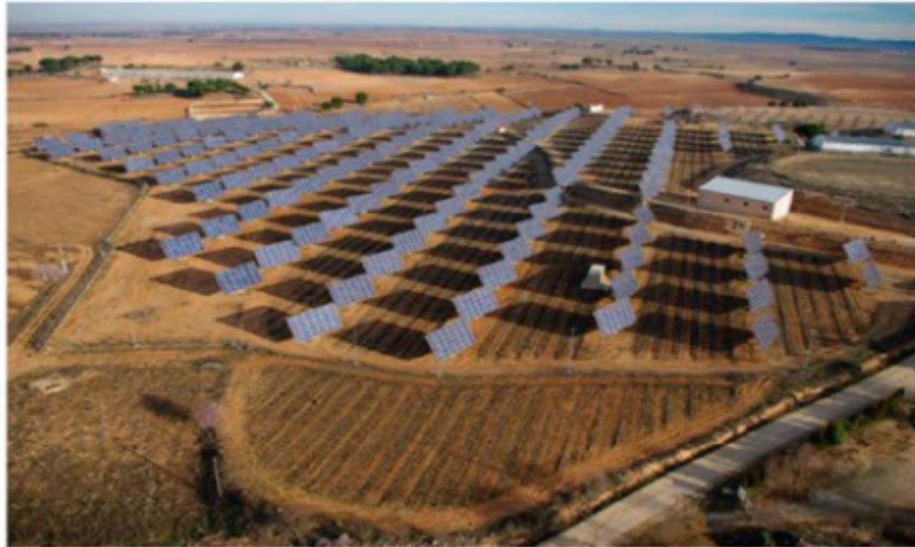
**Instalación 8** :Instalación de 1,8 MW realizada juntamente con una plantación de ciruelos de 13,1 ha (Figura 43). Los módulos fotovoltaicos se dispusieron sobre 180 seguidores de dos ejes. También, desarrollada por Tornasol, comparte múltiples características con Huerto Carrasco.
