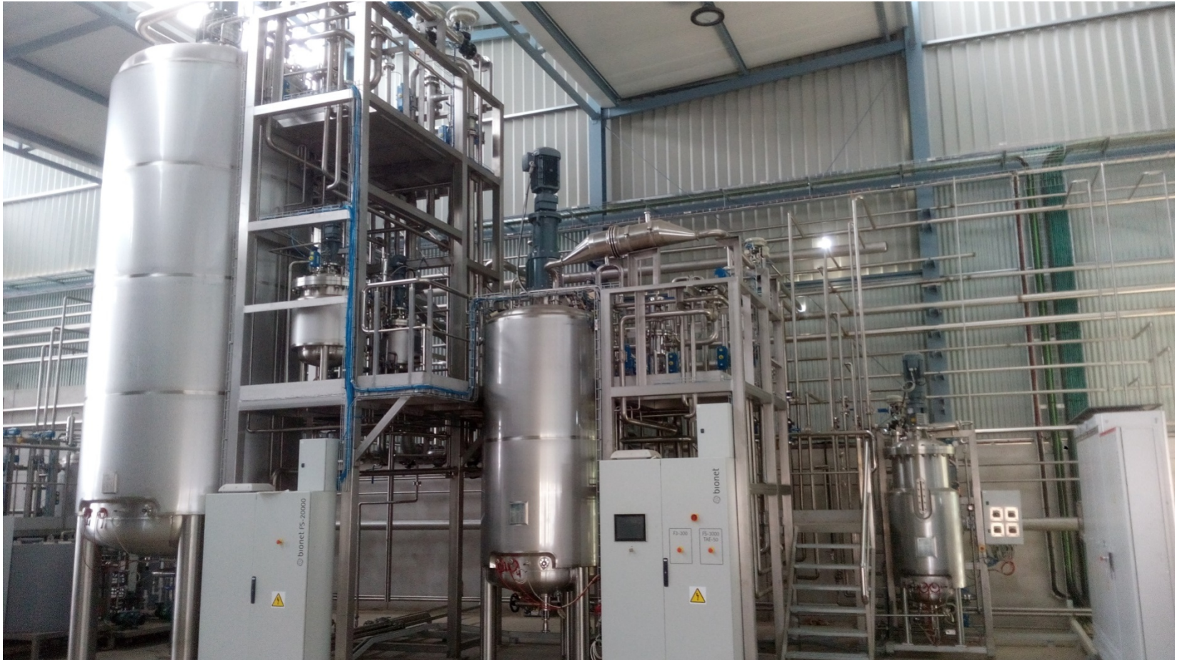
Tren de fermentación: fermentadores de 300 L, 3000 L y 20000 L
