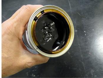
El **bio-bitún** corresponde a la fracción orgánica pesada del líquido. Puede ser empleado en la preparación de mezclas bituminosas para el asfaltado de carreteras.
