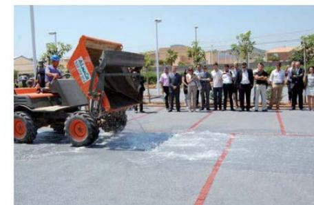
Figura 45. Pavimento permeable en zona de estacionamiento en el municipio de Benaguasil (Valencia). Fuente: Imagen cedida por PMEnginyeria.
