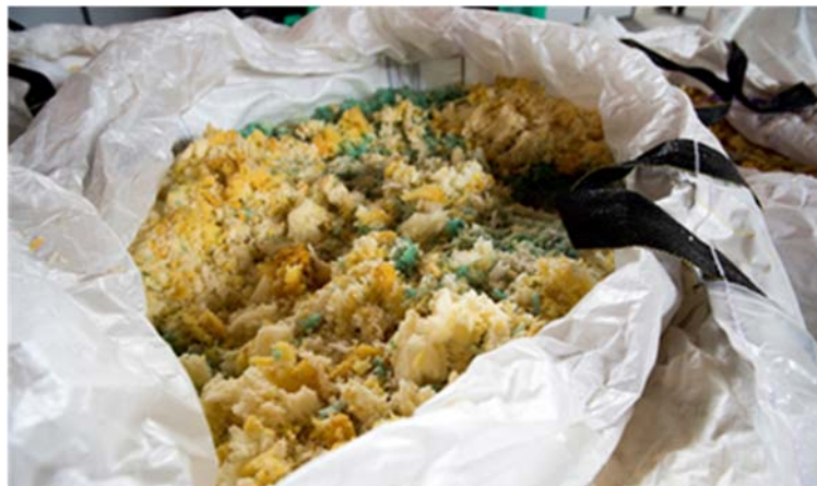
(Materias primas obtenidas tras el tratamiento mediante tecnología fragmentación 3D)
