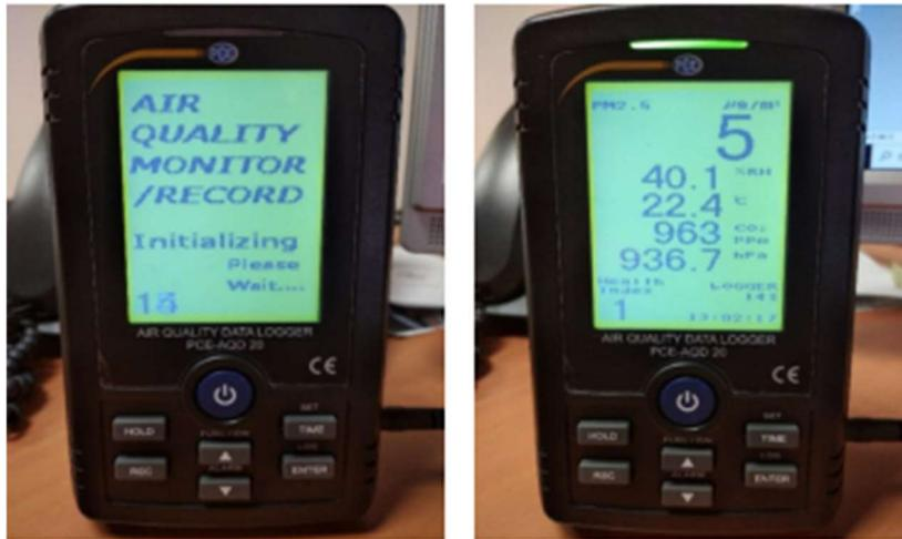
Figura 6.3: Equipo de monitorización PCE AQD 20 utilizado en la campaña.
