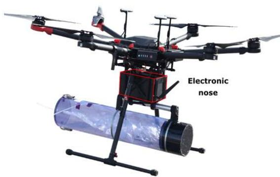
⇒ Se diseñó, construyó y testeó una nariz electrónica para determinar la concentración de olor ( $uo_E/m^3$ ) en EDARs a partir de concentraciones de gases
