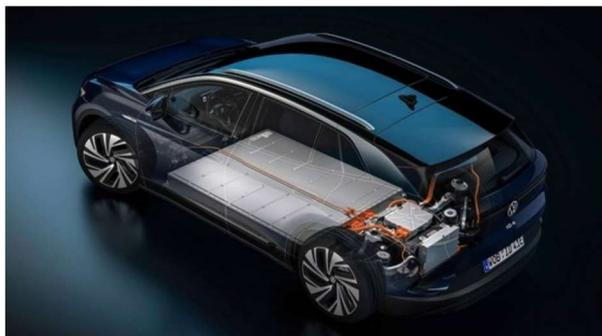
**Figura 10.19:** Volkswagen ID4 y disposición de la batería y BMS en el vehículo.
