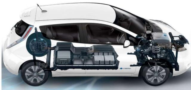
Figura 10.17: Nissan Leaf y disposición de la batería y BMS en el vehículo.
