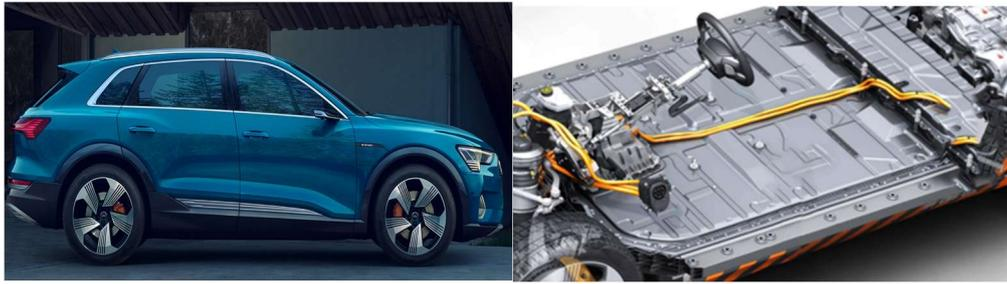
**Figura 10.21. Audi e-tron y disposición de la batería y BMS en el vehículo.**
