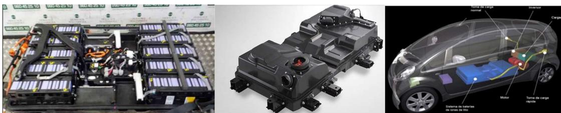
Figura 10.11: Conjunto ensamblado de las celdas y el Sistema de Gestión de la Batería, así como disposición de las baterías en los modelos Peugeot iOn, Mitsubishi i-MiEV y Citroën C-Zero.
