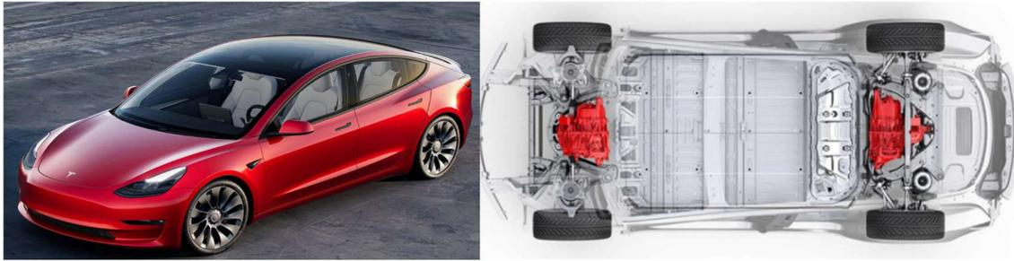
Figura 10.14: Tesla Modelo 3 Long Range y disposición de la batería y BMS en el vehículo.
