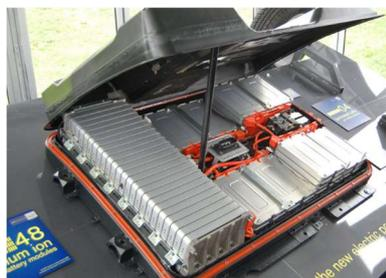
Figura 10.18: Detalle de la batería y BMS del Nissan Leaf.
