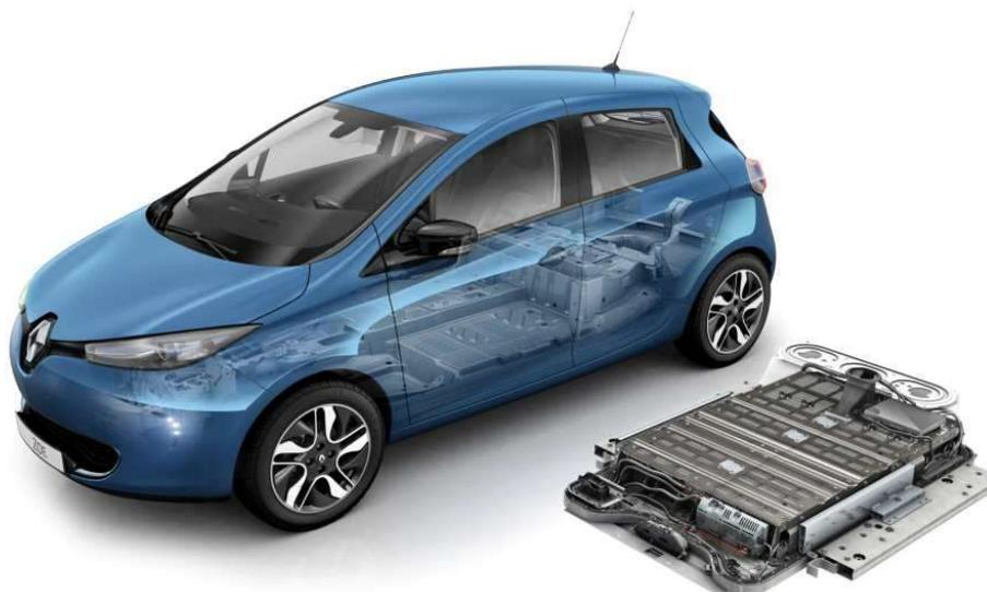
**Figura 10.13:** RENAULT Zoe, disposición de las baterías en el vehículo y conjunto ensamblado de las celdas y el Sistema de Gestión de la Batería (BMS).
