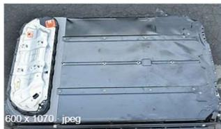
Figura 10.15: Conjunto de batería y BMS desmontado para mantenimiento del Tesla Modelo 3.
