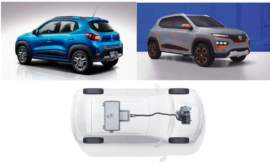
Figura 10.12: Renault City K-ZE y Dacia Spring y disposición de la batería.
