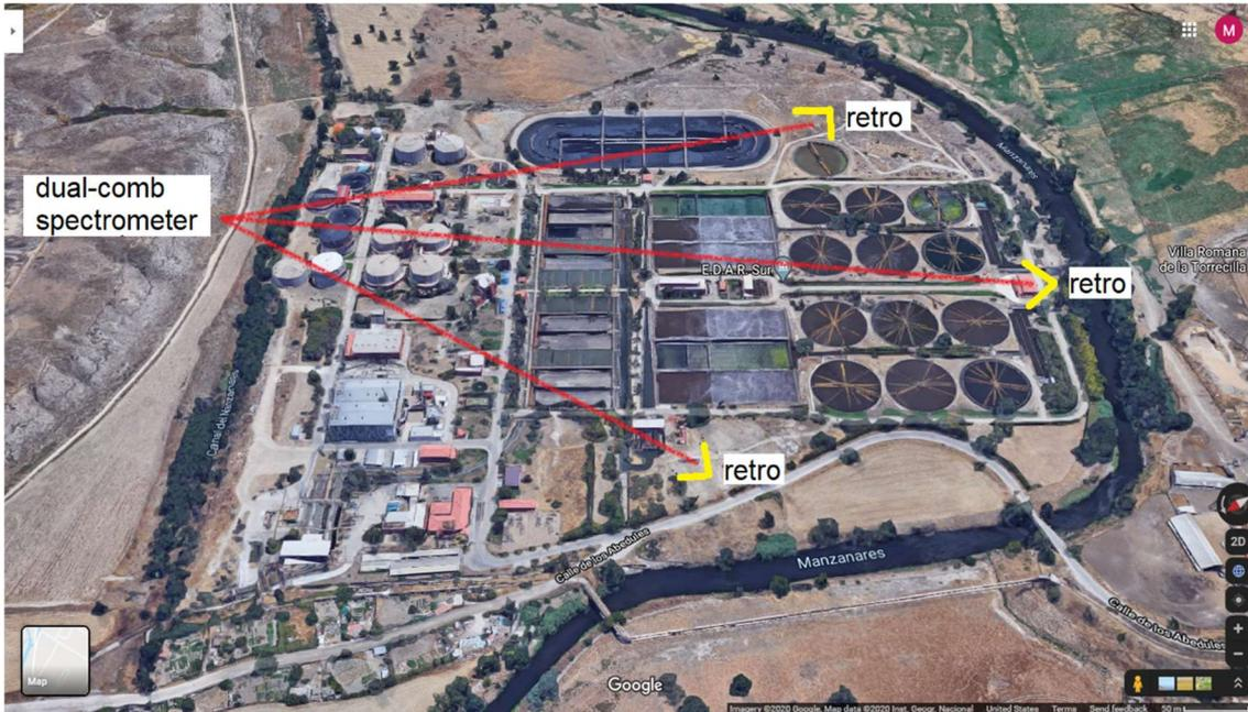
**Figura 7.4:** Monitorización distribuida de una planta de tratamiento de aguas mediante un espectrómetro dual-comb.
