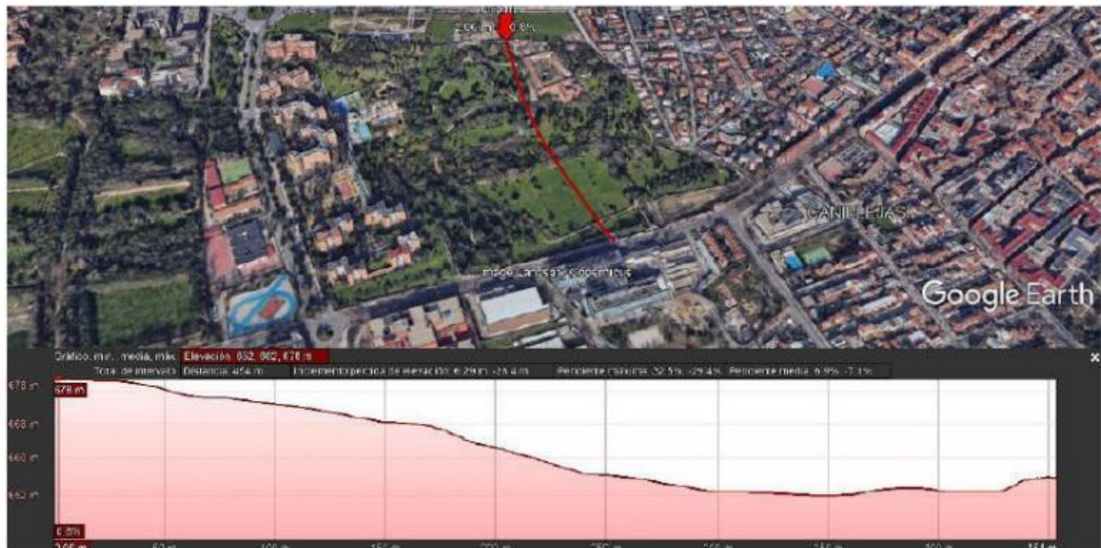
Esquema topográfico de la finca con las curvas de nivel a 1 m, imagen satelital con modelado digital obtenida con Landviewer y perfil NO-SE de Google Earth.
