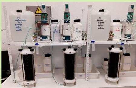
Las condiciones experimentales de este ensayo permiten estudiar el **comportamiento** frente a la lixiviación, identificando las sustancias que son liberadas de forma rápida o lenta y el mecanismo de lixiviación predominante. El resultado final, cuando se alcanza una relación líquido-sólido de 10 litros por kg de materia seca (30-45 días dependiendo de la densidad del material estudiado), permite extrapolar el comportamiento real en aplicaciones de materiales de construcción a largo plazo.
