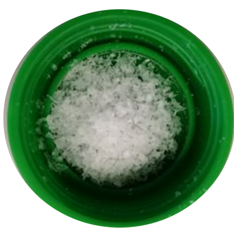
Figura 2. Microplásticos artificiales usados en los ensayos de degradación
