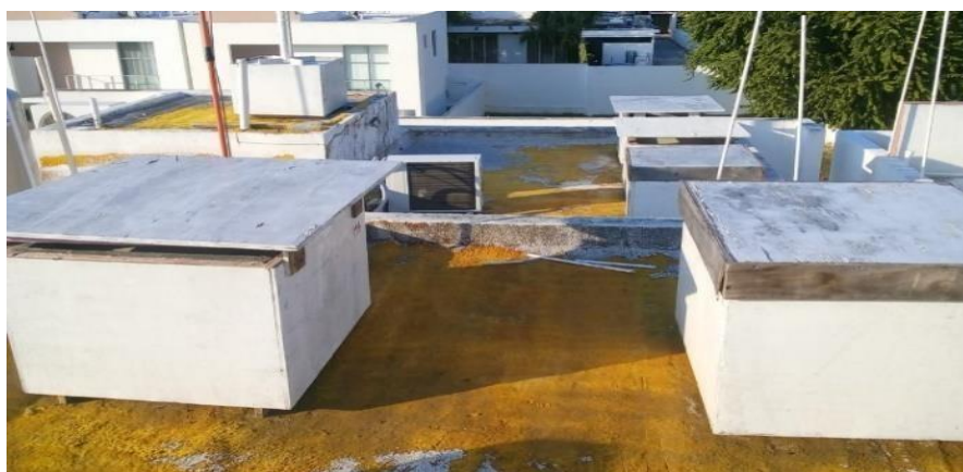
Figura 2. Disposición experimental durante la monitorización de datos de los SEEI con sistemas pasivos de enfriamiento suplementarios
