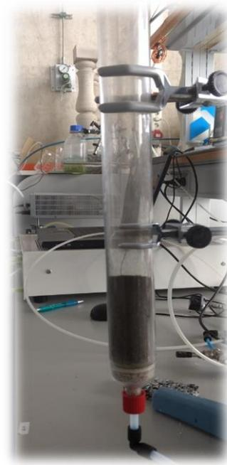
Figura 5. Cámara de contacto para el ensayo de NO<sub>2</sub>. Fuente CARTIF.
