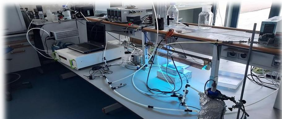
**Figura 4.** Instalación experimental para los ensayos fotocatalíticos. Fuente CARTIF.
