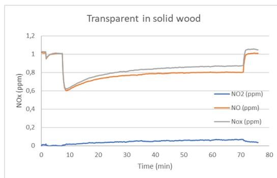
Figura 13. Resumen de los resultados del ensayo con la norma ISO 22197-1 al recubrimiento desarrollado para la madera. Elaboración propia.
