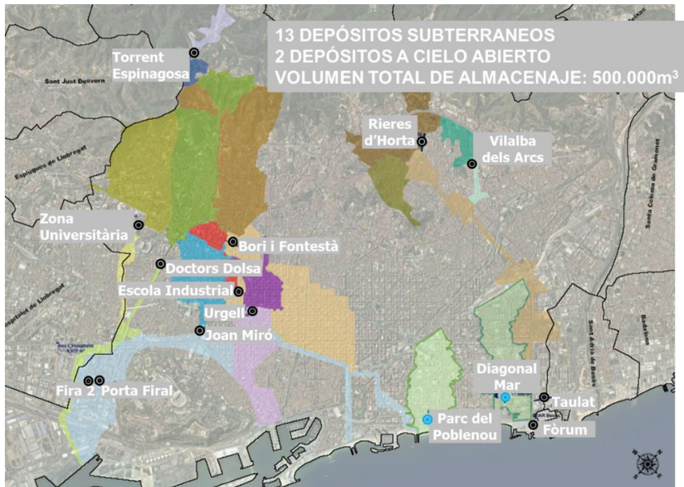
Figura 14. Tanques de tormenta de Barcelona (Fuente: BCASA)
