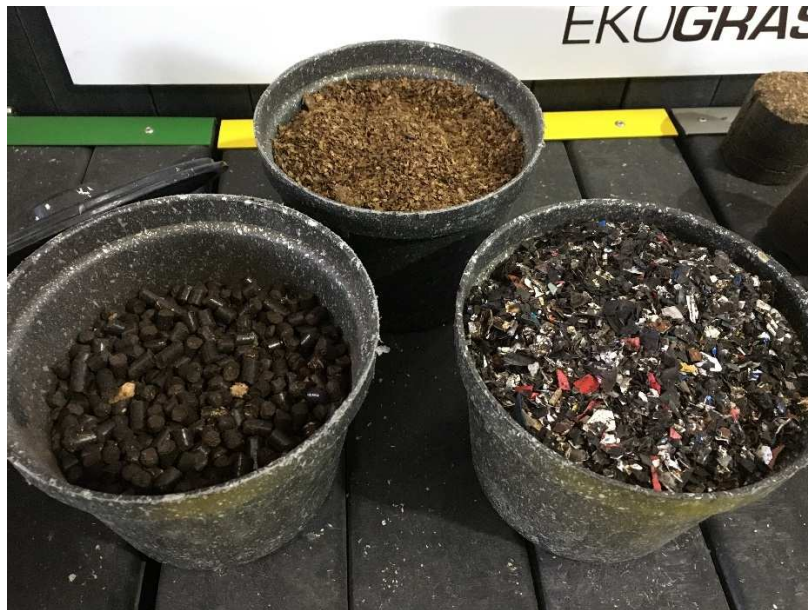
Figura 5. Resultado del procesado de los residuos de café: a) marro obtenido a partir de los posos y empleado en los kits de cultivo (arriba); b) pellets para calefacción (izquierda); y c) grazna para la fabricación de elementos plásticos (derecha) (Fundación Cristina Enea).
