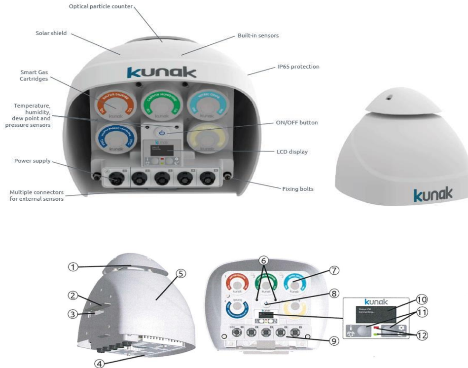
Figura 4 – Partes de un Kunak AIR Pro
