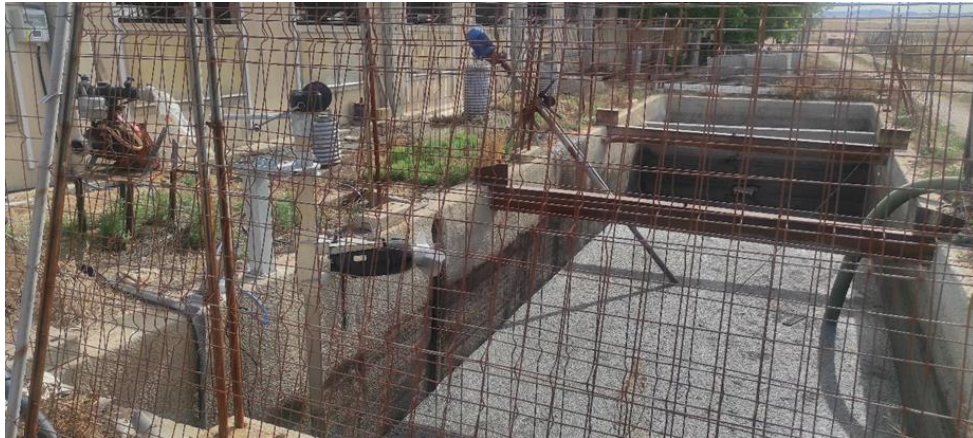
Figura 10. Agitador de purines en balsa de almacenamiento preexistente
