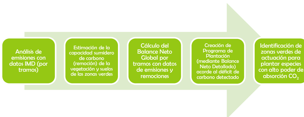
Figura 7. Procedimiento de estudio del balance neto de carbono. (Estudio de Balance Neto de Carbono para Determinadas Vías Competencia del ECIT)
