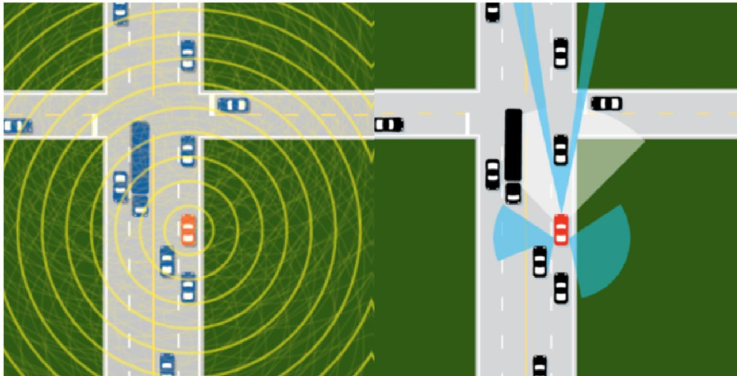
***Diferencia entre un sistema de seguridad en la circulación basado en V2X y uno convencional***
