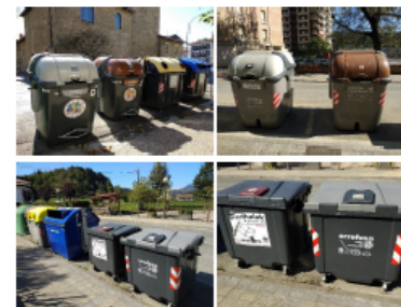
Figura 2. Contenedores que incorporan un sistema de apertura mediante tarjeta magnética: contenedores de carga lateral en Zaragoza; Pái Vasco (superior izquierda y derecha); País Vasco (superior derecha); y de carga frontal en Orléans (Francia). Fuente: Institut Citad, 2018.
