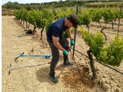
Perforación de hasta 70 cm para instalar las sondas.
