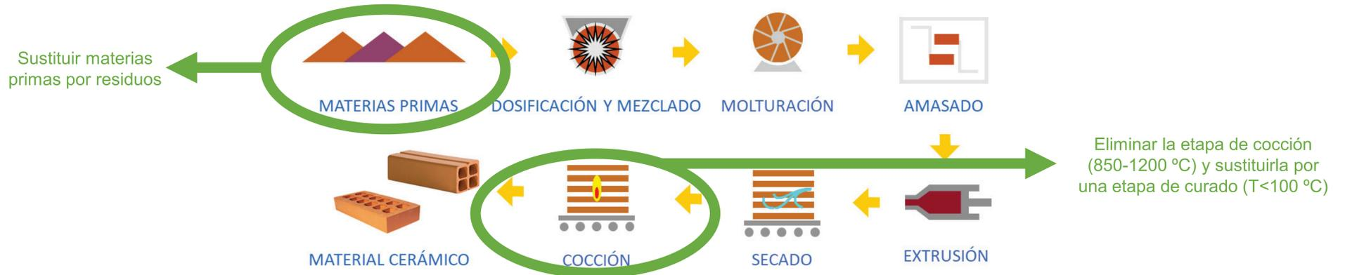
Figura 1. Proceso tradicional de obtención de material cerámico por extrusión.
