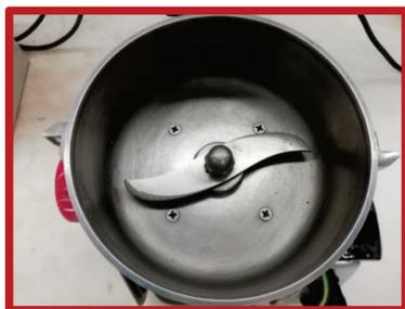
Figura 3. Mezcladora de alta energía (24500 rpm).
