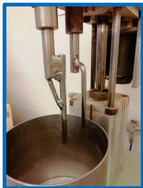
Figura 2. Mezcladora de baja energía (360 rpm).
