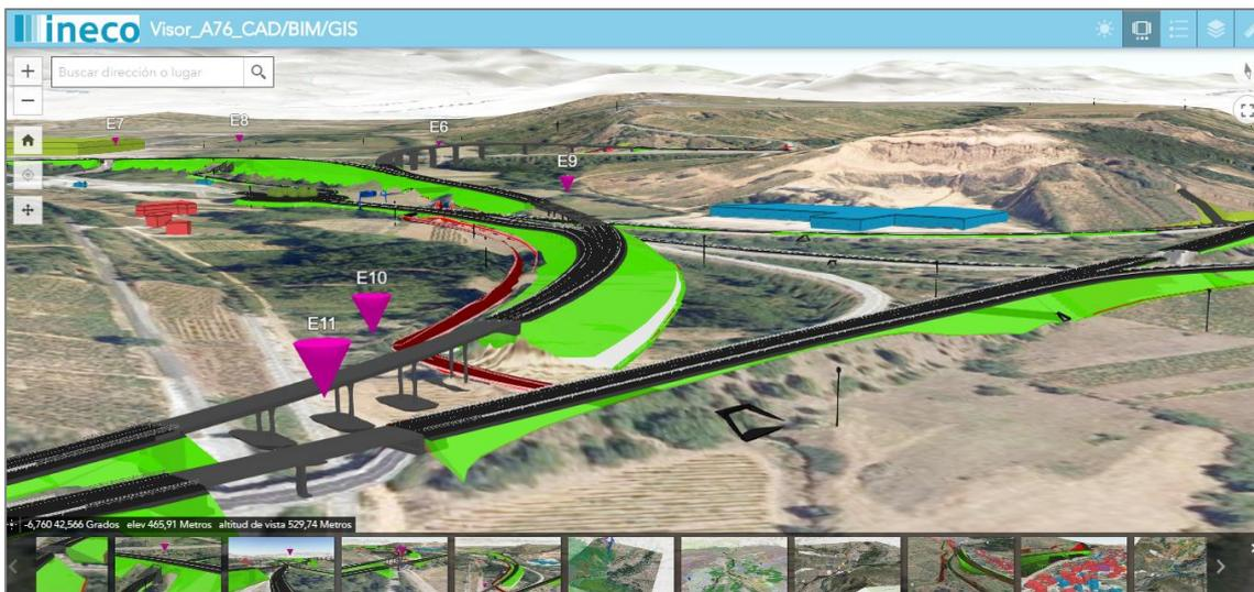
Figura 9. Imagen general del visor de integración BIM-GIS
