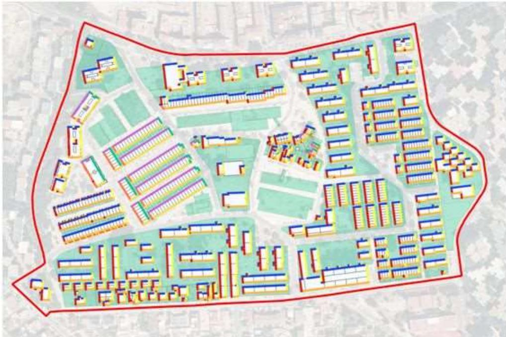
**Figura 5.** Análisis de la orientación y cuantificación de las fachadas de la edificación para el barrio de Canillas[21].
