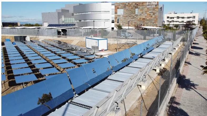
Figura 3. Instalación de los concentradores fabricado en el banco de ensayos de Móstoles
