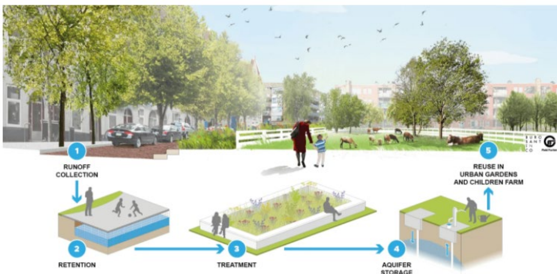
Figura 4. Esquema sobre el funcionamiento del sistema Bluebloqs que será instalado en el parque Cromvliet , en La Haya ( https://www.circularwatersystems.eu/ ) [11]
