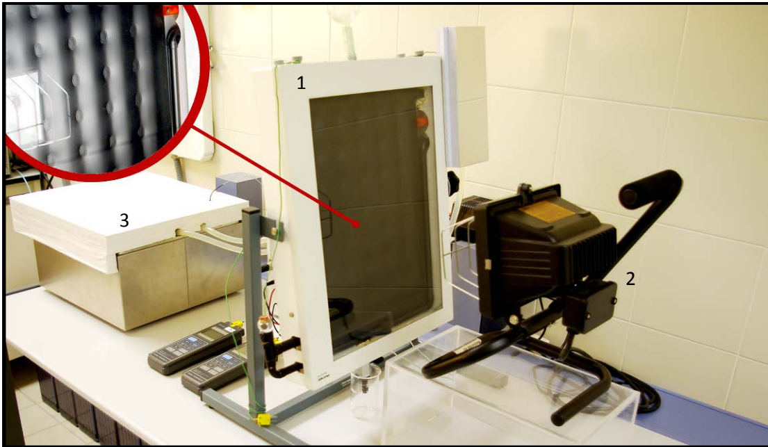
Figura 4. Modelo experimental de instalación de agua caliente sanitaria
