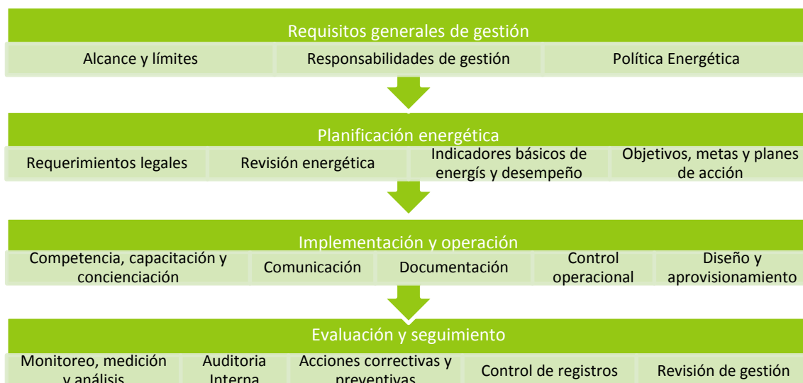
Figura 3: Diagrama de funcionamiento de un SGEN según la norma ISO 50001. Elaboración propia
