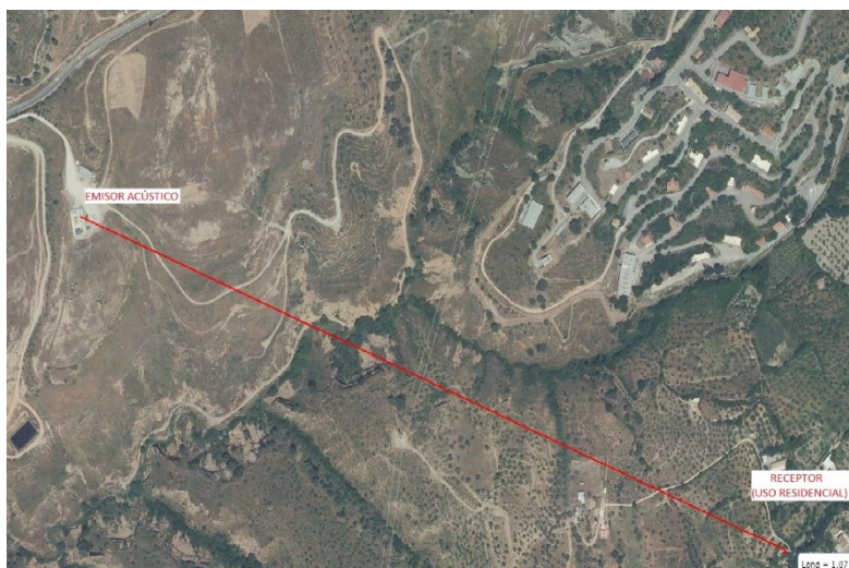
Figura 3: Punto de medida receptor y distancia al emisor
