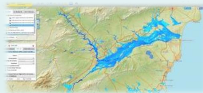
Inundación de periodo de retorno de 500 años del río Segura tras su confluencia con el río Guadalentín Fuente: Visor del SNCZI
