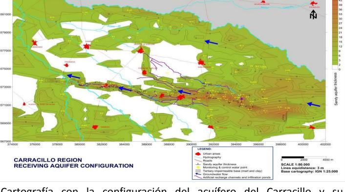
Cartografía con la configuración del acuífero del Carracillo y su funcionamiento. El volumen del agua de recarga en la zona de cabecera (Este) se dirige de manera natural a través del acuífero hasta la descarga en el río Pirón (Oeste), y puede ser interceptada durante todo el circuito por los pozos de riego, evitando así el tendido de tuberías. El Carracillo, Castilla y León.
