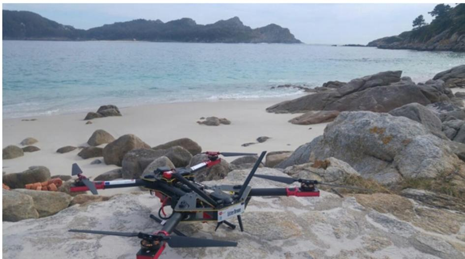
Figura 1.- Dron multirrotor empleado en el trabajo de campo del proyecto LitterDrone
