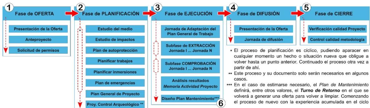
Ilustración 3. Esquema del Proceso General de la Metodología Gemosclera
