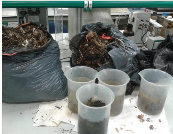
Figura 2. Proceso de separación manual de los tallos y rizomas de Posidonia oceanica
