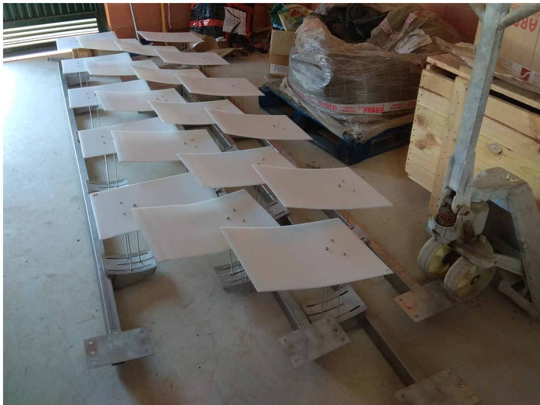
Stirring Blades (SBTech) listos para su instalación en el tanque LEAR
