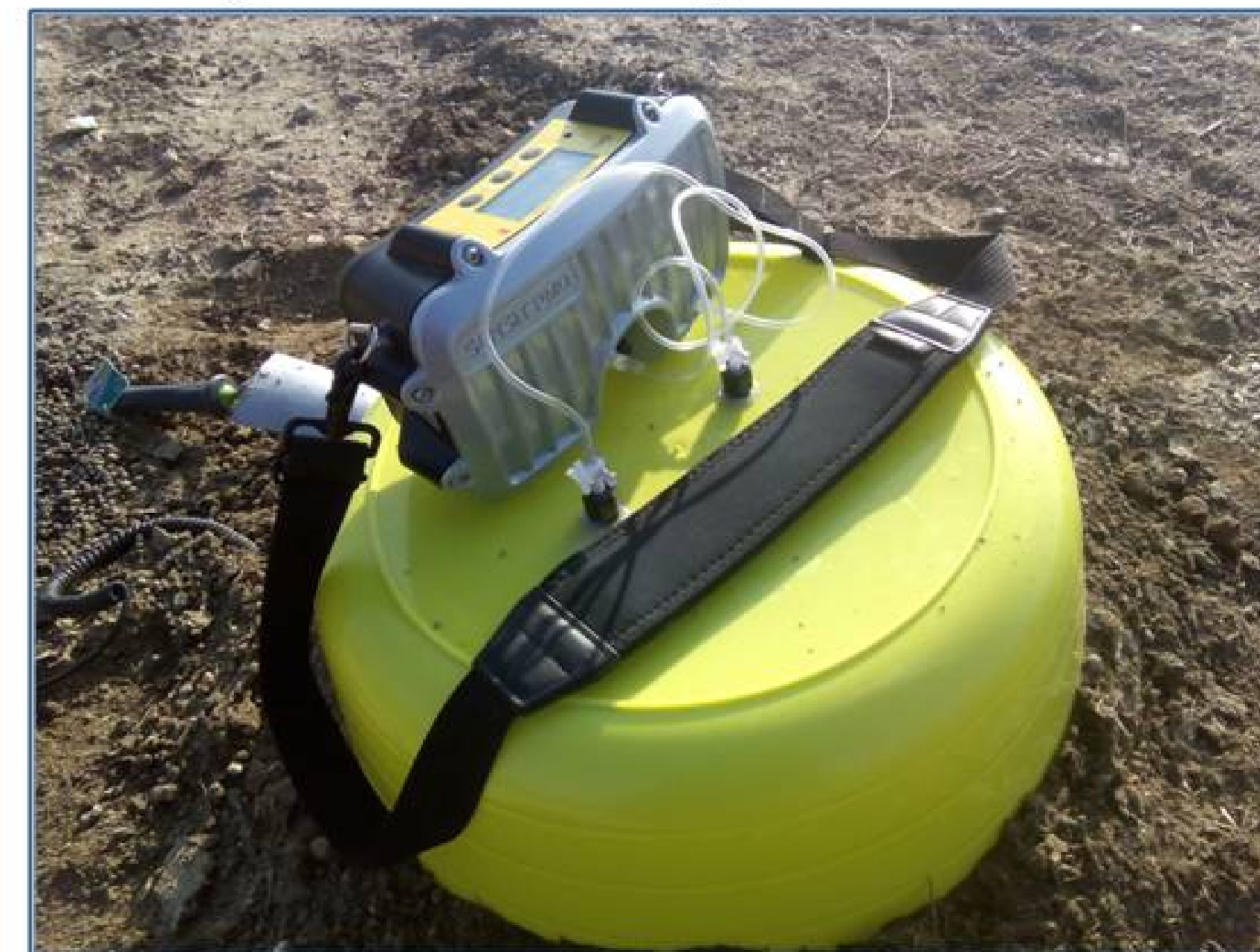
Figura 5. Campana de flujo durante una medición en la superficie de un vertedero
