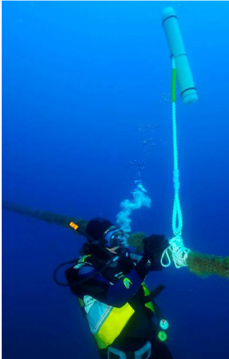
Fotografía 3: Momento de la colocación de uno de los hidrófonos en la línea de anclaje de una granja de acuicultura.
