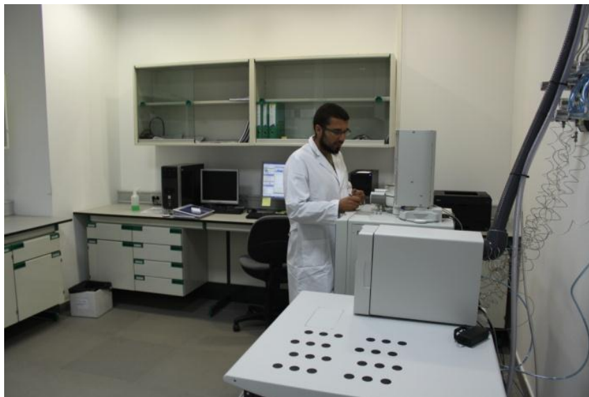
Fotografía 6: Proceso de introducción de las muestras en el muestreador automático del sistema de espectrometría de masas, compuesto por un analizador elemental acoplado a un espectrómetro de masas de relaciones isotópicas a través de un sistema Conflo.
