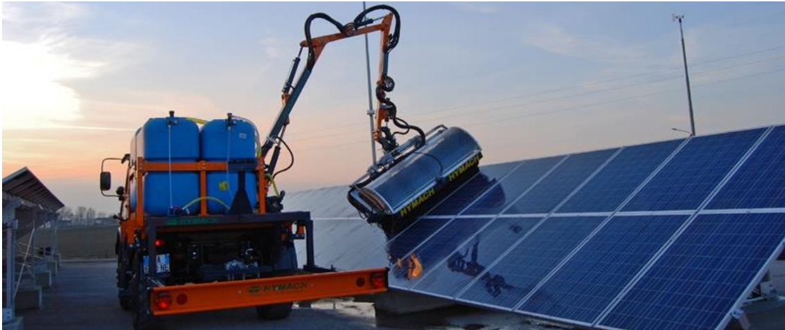
Fig. 2.2. Limpieza de los módulos. Fuente: Cadena y Montero (2007).
