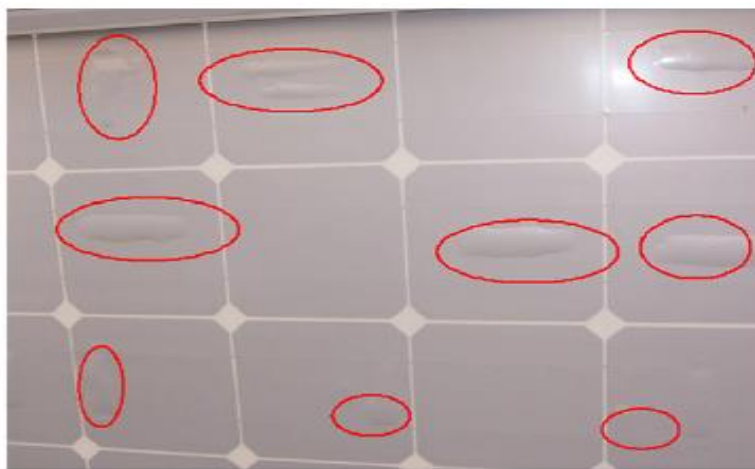
Fig. 2.8. Módulo con burbujas. Fuente: Cadena y Montero (2007).
