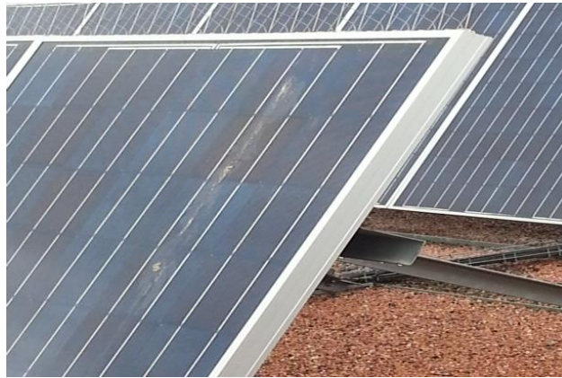
Fig.2.4. Módulo con excrementos de aves. Fuente: Cadena y Montero (2007).
