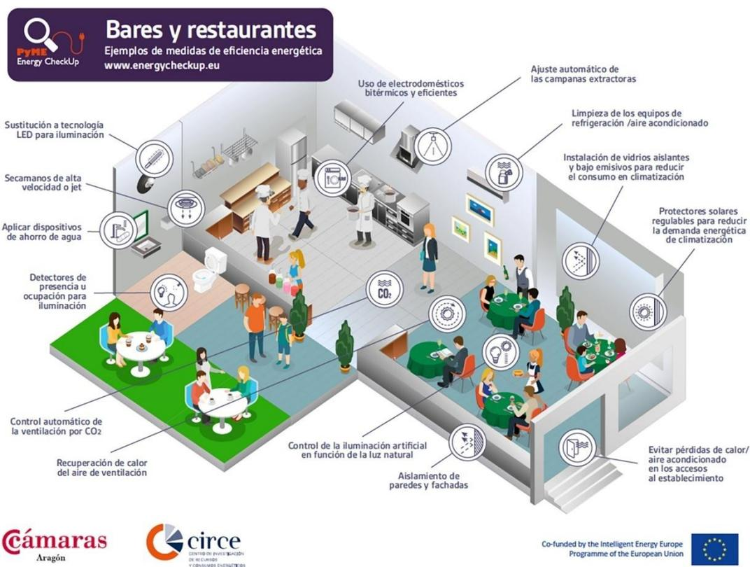
Figura 2. Ejemplos de medidas de eficiencia energética en bares y restaurantes.
