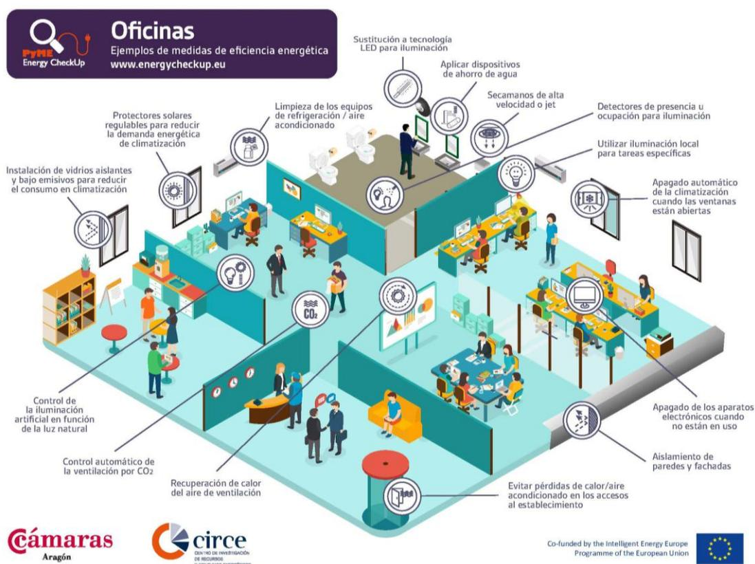
Figura 4. Ejemplos de medidas de eficiencia energética en oficinas.
