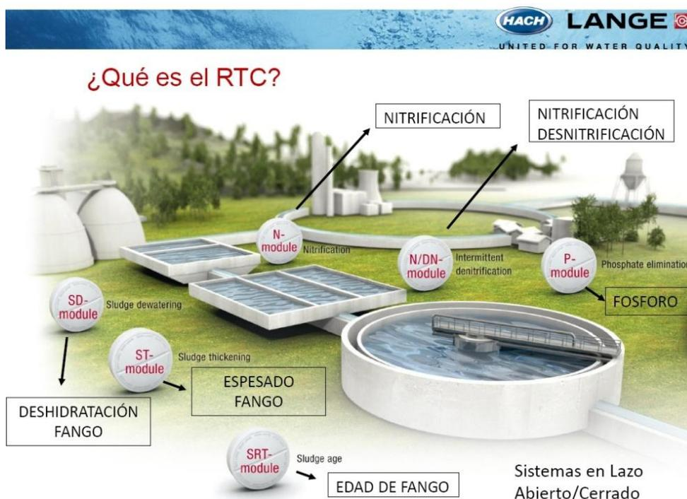
Figura 11. Módulos RTC de Hach Lange
