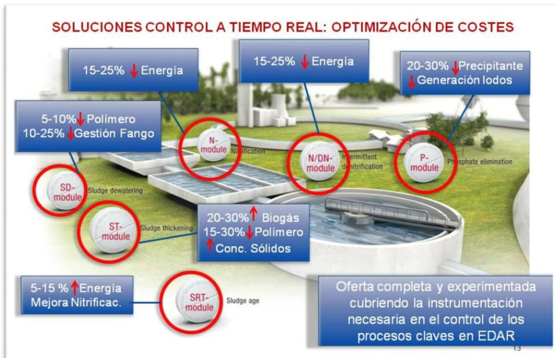
Figura 12. Valores medios de ahorro de los módulos RTC según datos de Hach Lange.
