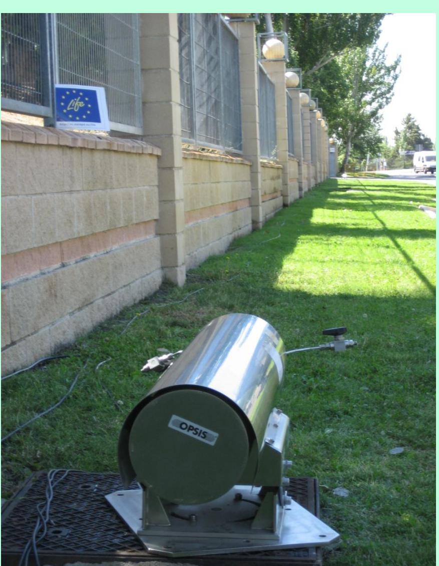
Detalle del receptor ER150 del sistema DOAS utilizado para la medida de los contaminantes NO, NO 2 y O 3 en calle (longitud del camino óptico = 80 m)
