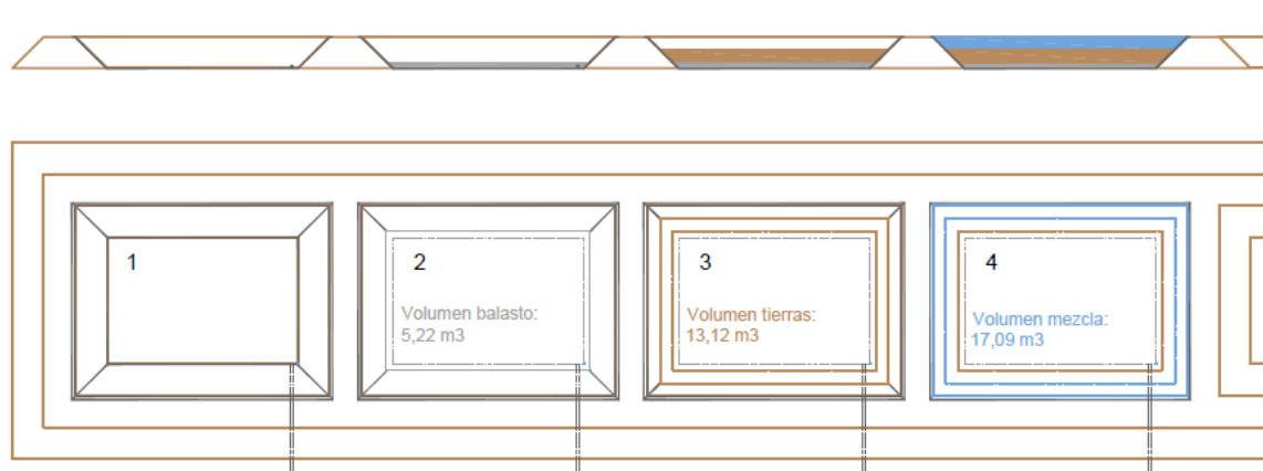
Figura 1. Construcción de parcelas: lámina impermeable y tubo de drenaje (1), capa drenante (2), capa base (3) y capa superior con la mezcla de tecnosuelo (4).
