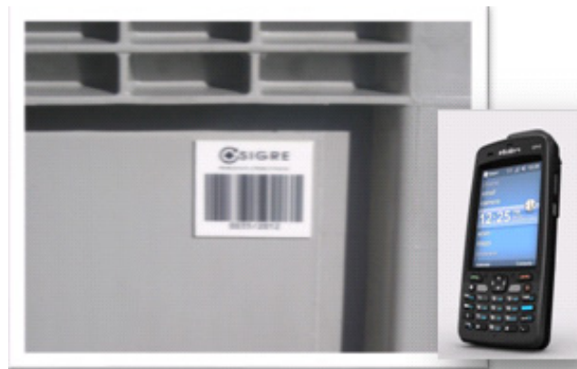
Etiqueta de código de barras en contenedores y equipo lector de datos “PDA”
