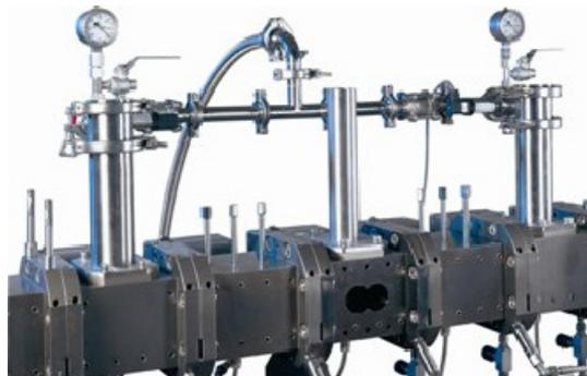
*Figura 4. Vacío e inyección múltiple.*
