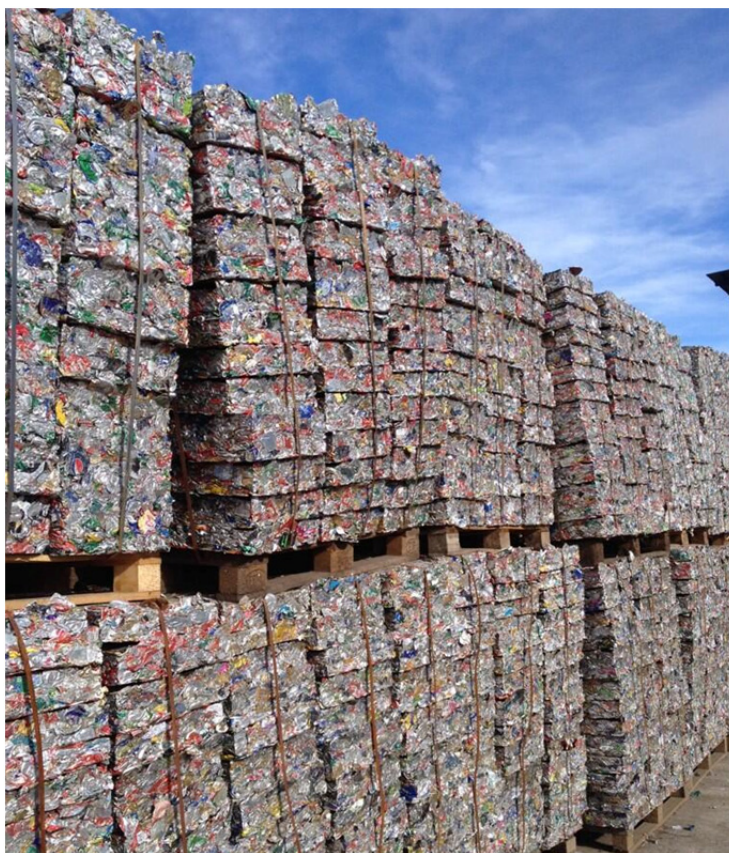
Figura 4. Material procedente del reciclado de envases de acero listo para su envío a acería eléctrica.
