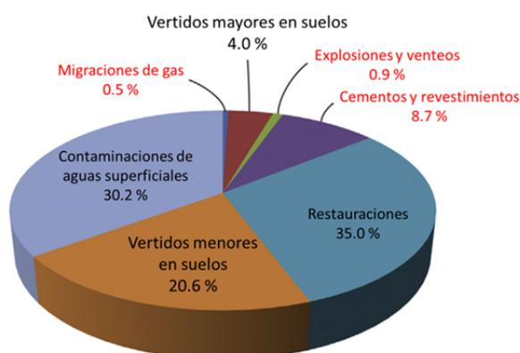
**Figura 3: Desglose de las 1.144 notificaciones de infracciones en pozos de hidrocarburos en Pennsylvania (USA), entre 2008 y 2011. En rojo, las relacionadas con fallos de integridad de pozo. Modificada de [19].**
