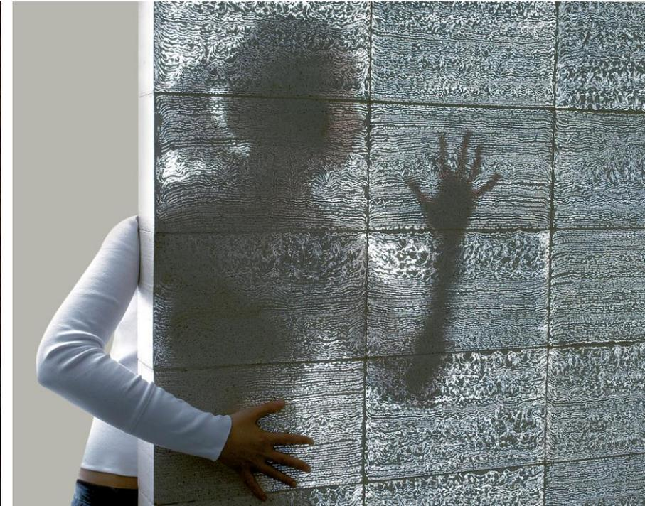
Hormigón Taslucido (Litracon - Ligth Transmiting Concrete)
