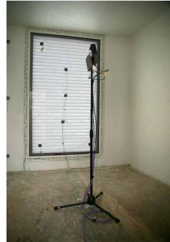
Pedestal con sensores de temperatura y humedad del aire
