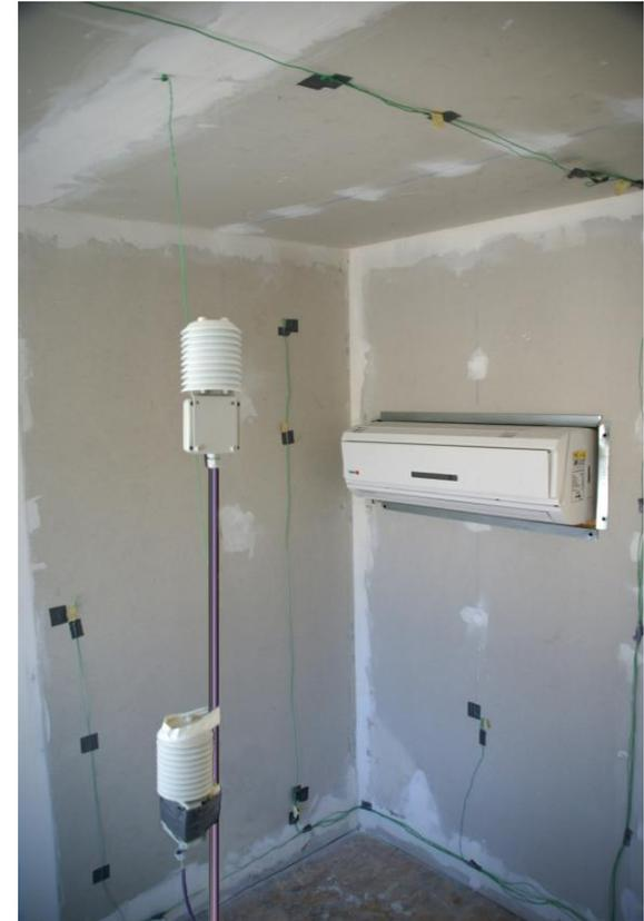
Pedestal con sensores de temperatura a tres alturas
